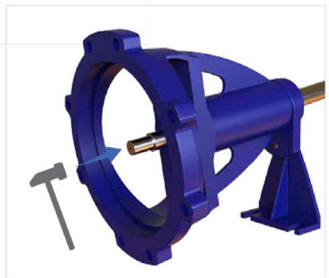
شکل ۲۵- خارج نمودن محور از روی پایه یاتاقان
