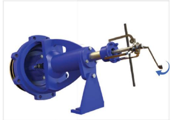
شکل ۲۳- خارج نمودن نیمه کوبلینگ
