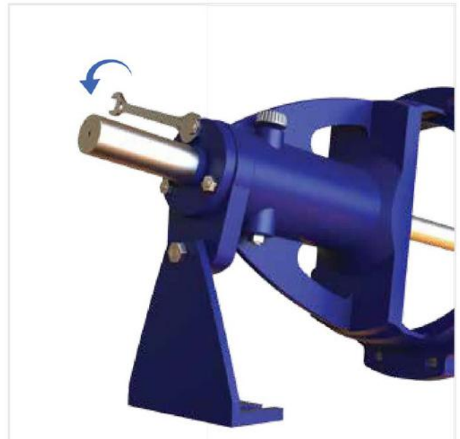
شکل ۲۴- باز کردن درپوش بلبرینگ
