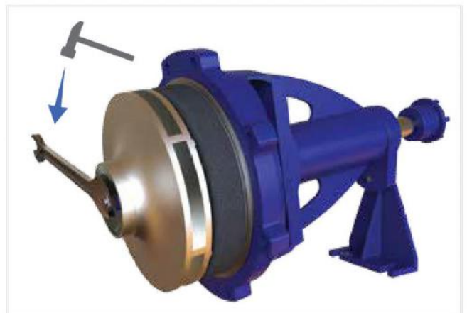
شکل ۲۰- باز کردن مهره شش گوش پروانه
