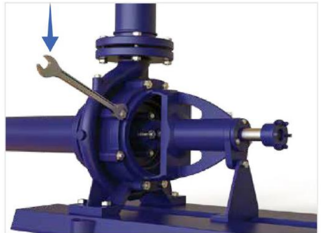
شکل ۱۸- باز کردن مهره های شش گوش محفظه
