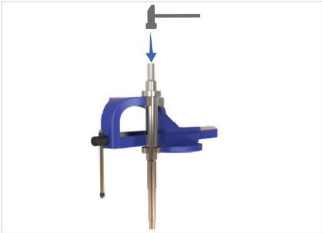
شکل ۲۶- خارج نمودن بلبرینگ از محور
