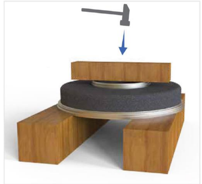
شکل ۲۷- سوار کردن رینگ سایشی
